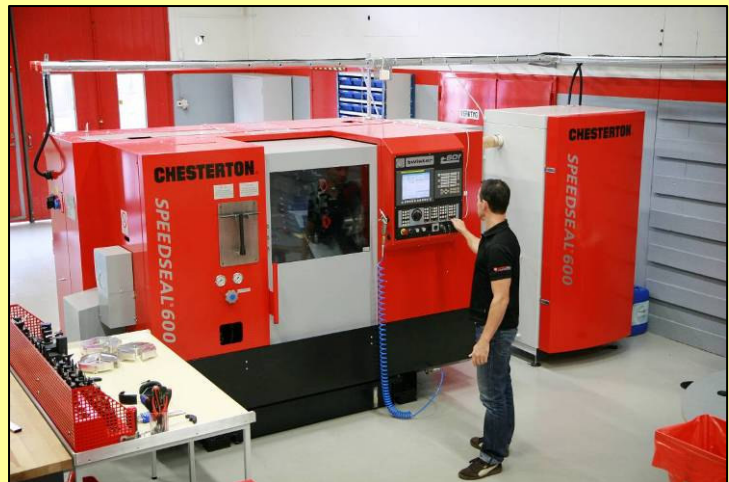
Bilden visar Chesterton/ SpeedSeals utrustning i Karlshamn för tillverkning av polymertätningar upp till diameter 580 mm. Dimensioner upp till 1400 mm kan svarvas hos SpeedSeal i Tyskland.
