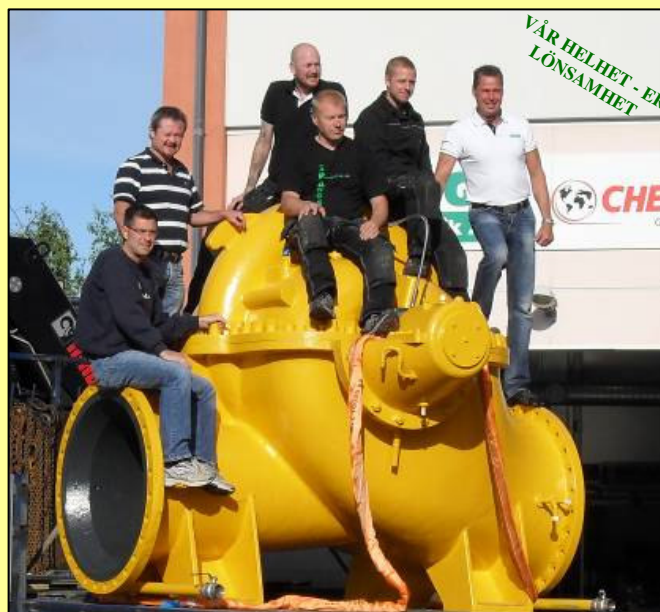
Delar ur Spångs anställda har samlats uppe på den ena av fjärrvärmepumparna som är uppgraderad och skall transporteras och monteras på plats hos kund.
