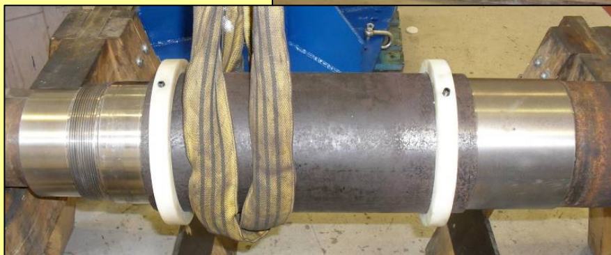
Axeln efter metallisering av lagerlägena samt monterade fettbussningar (de vita) för att håll kvar fettet i respektive lager.
