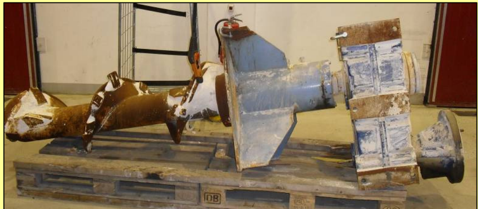
Skraven med lagringen i mitten och växellådan längst ut till höger i bild.
