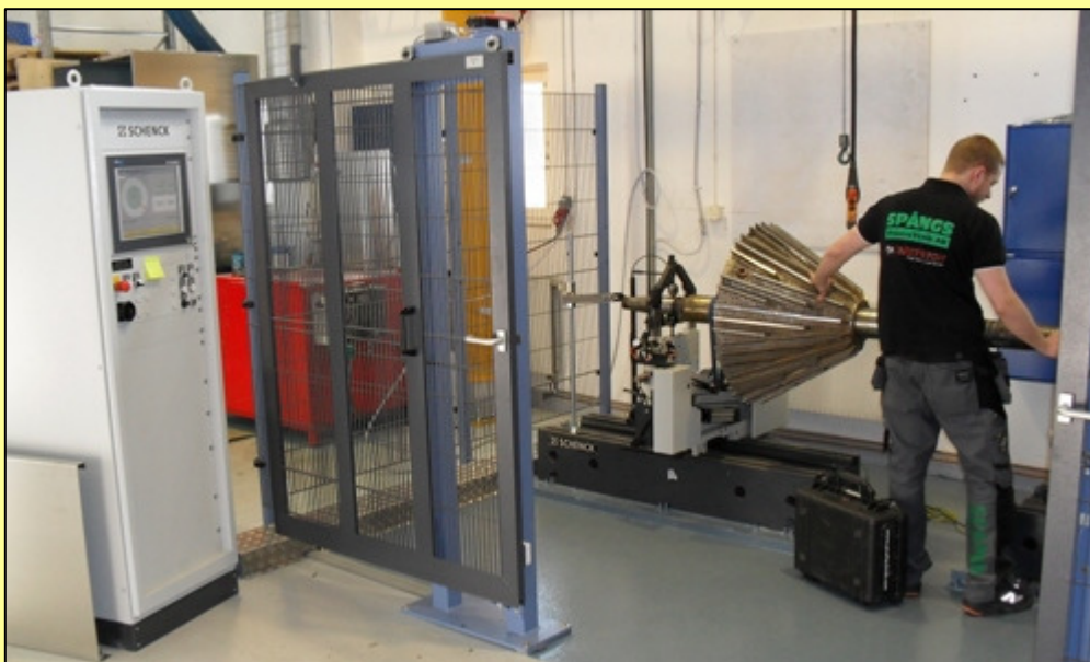
Balansering genomförs av kvarn på vår balanseringsmaskin.
