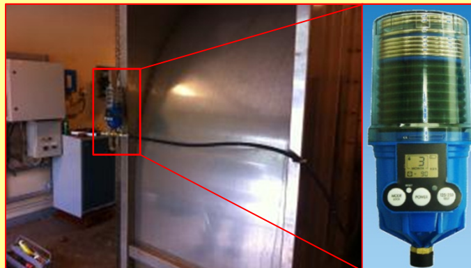
Till vänster syns placering av Lubri-Cup och dess två slangar som smörjer både det yttre och det inre lagret. Till höger en förstörd bild på en Lubri-Cup.
