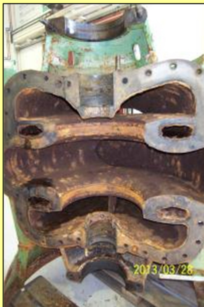
Pump isärtagen för kontroll och besiktning på serviceverkstad.
