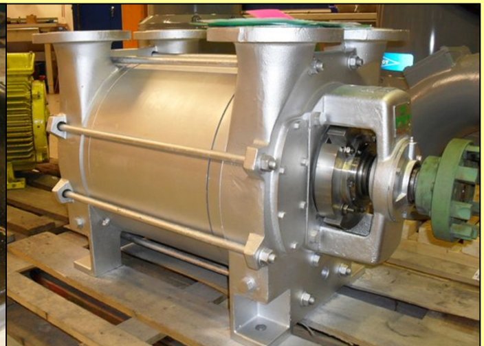
Bild 3. Vakuumpumpen som är kompositbelagd och utrustad med Chestertons patrontätningar är nu klar för leverans.
