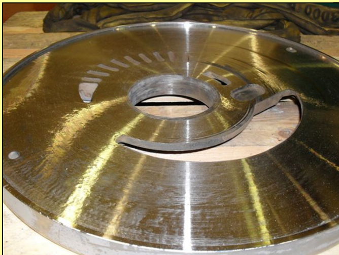
Bild 2. Svarvat och planat gavlar till huset.
