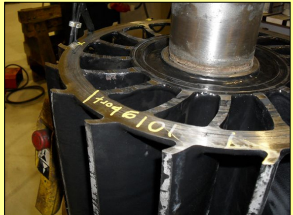
Bild 1. Svarvat och planat pumphjulsgavlar.
