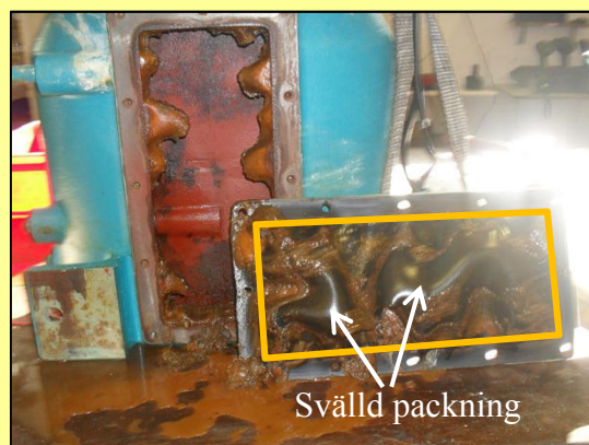
Svälld packning var troligen orsaken till varmgången hos pumpen.
